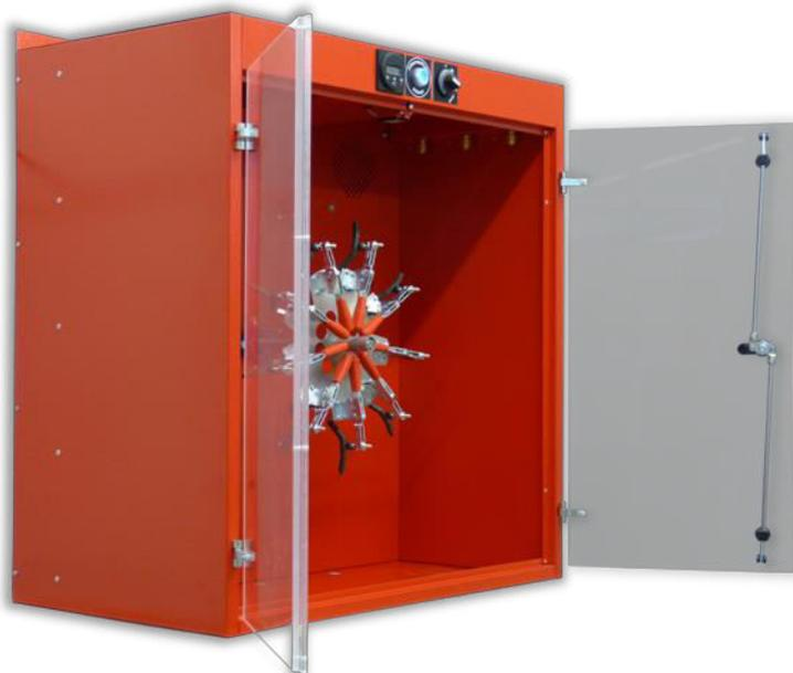
Unser Maskentrockenschrank MTS 1860 Color gewährleistet durch das ständige Drehen der Atemschutzmasken auf dem integrierten Drehteller eine effiziente und schonende Warmluftgebläse-Trocknung, sodass die Trockenzeit nur ca. 15 bis 30 Minuten beträgt. Durch das schnelle und einfache Klemmverfahren an der Sichtscheibe eignet sich der Maskentrockenschrank MTS 1860 Color für alle Maskentypen.
