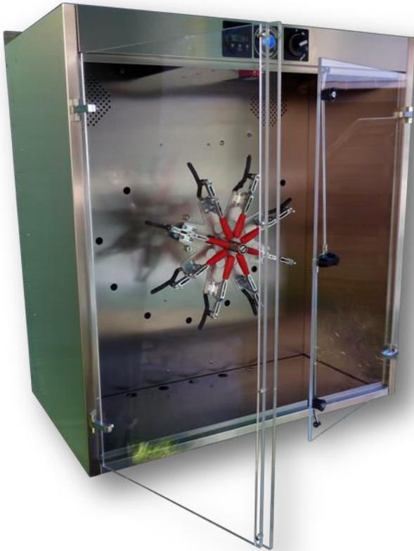
Unser Maskentrockenschrank MTS 1860 New gewährleistet durch das ständige Drehen der Atemschutzmasken auf dem integrierten Drehteller eine effiziente und schonende Warmluftgebläse-Trocknung, sodass die Trockenzeit nur ca. 15 bis 30 Minuten beträgt. Durch das schnelle und einfache Klemmverfahren an der Sichtscheibe eignet sich der Maskentrockenschrank MTS 1860 New für alle Maskentypen.
