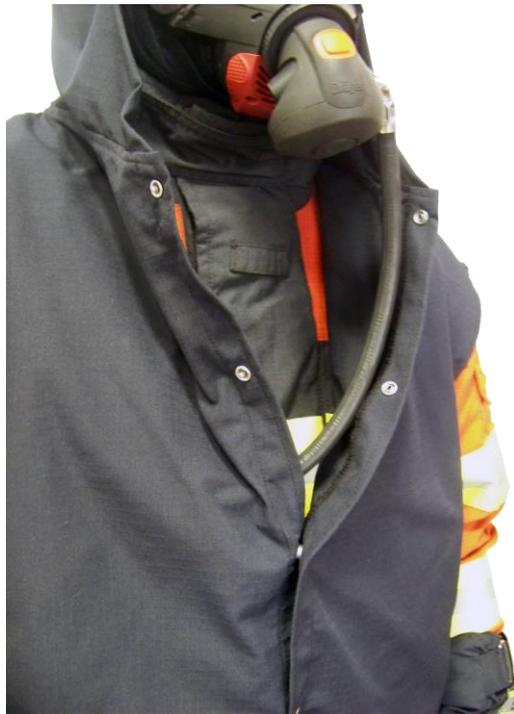
Die fünf angeordneten Druckknöpfe gewährleisten auch nach hoher Wärmebeaufschlagung ein sicheres Verschließen des Ponchos und er kann ohne Probleme jederzeit geöffnet werden. Die Durchführung des Druckmanometers, z.B. zur Kontrolle des Flaschendrucks, erfolgt durch den Ärmel oder zwischen den Druckknöpfen. Wir verzichten gänzlich auf Klettverschlüsse, da diese bei hoher Temperatur verbrennen können. Durch die Druckknöpfe kann das nicht mehr passieren. Dies macht unseren Poncho langlebiger.
