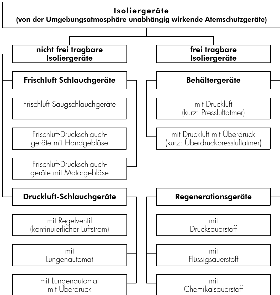
Bild 20: Einteilung der Isoliergeräte
