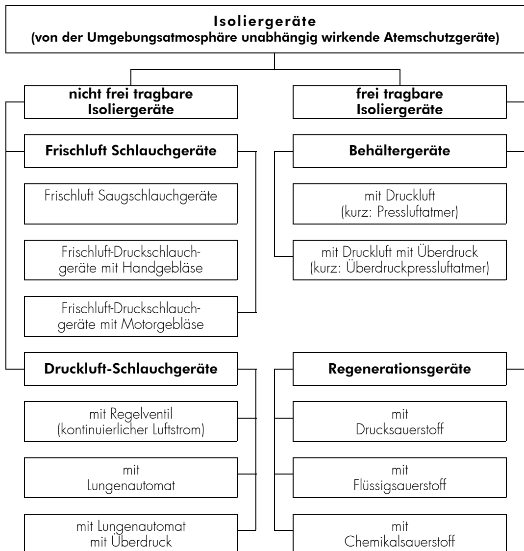
Bild 5: Einteilung der Isoliergeräte
